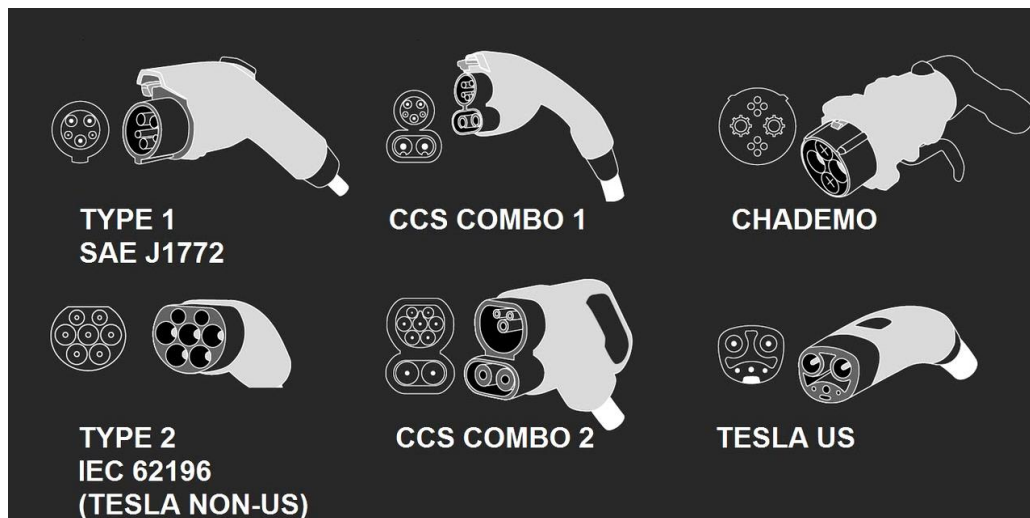
Obrázek 14: Přehled používaných nabíjecích konektorů
