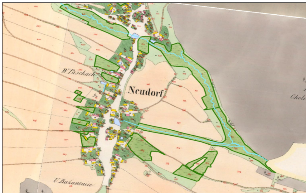
Obrázek 5: Vektorizace mapy Stabilního katastru pro k. ú. Nová Ves pod Pleší se zachycenými polygony mokřadních luk (zeleně) a liniemi vodních toků (modře).
