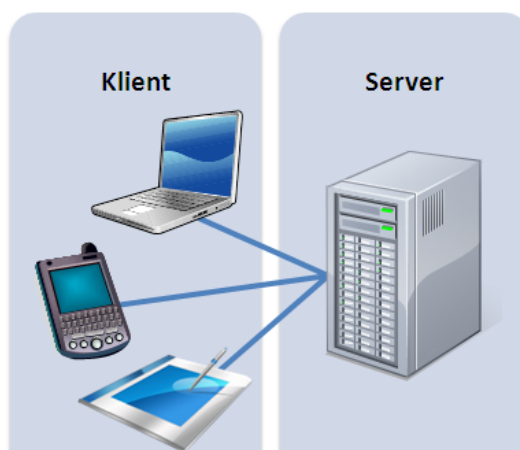
Obrázok č. 6: Klient – Server architektúra
