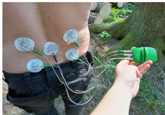
Obrázek 7 – Napojení snímačů na měřicí přístroj Archiv autora
