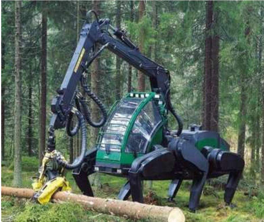
Obrázek 3 - Kráčivý harvester značky John Deere (Autor: Hans Lucero S.) Dostupné z: http://maquinasforestales.blogspot.com/
