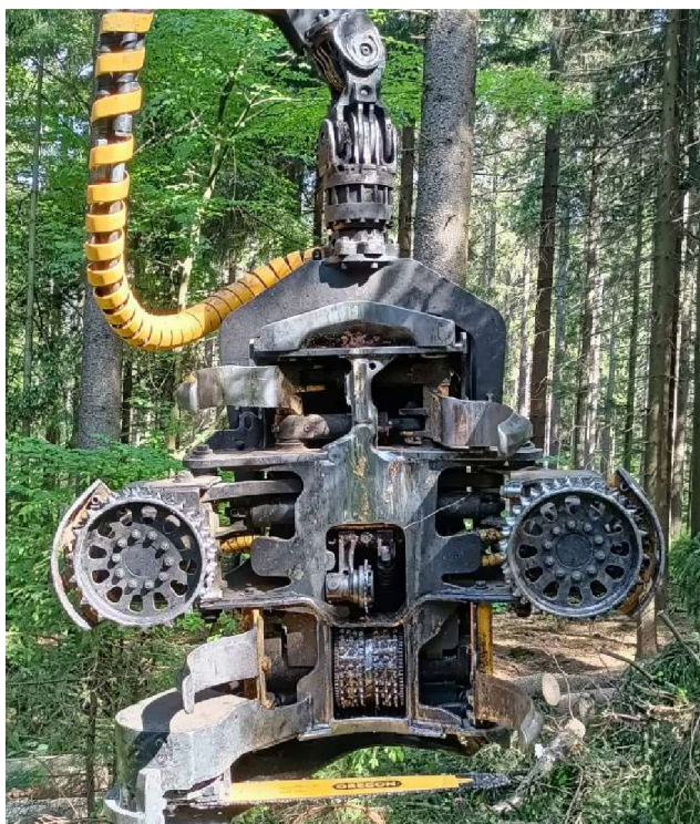
Obrázek 4 - Těžební hlavice harvestoru Ponsse Archiv autora
