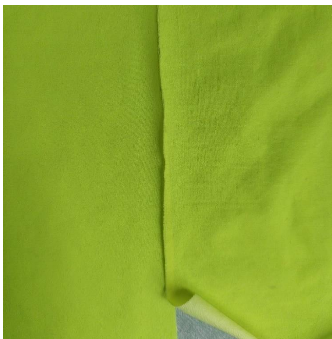
Obrázek 31. Vzhled M2 líc: před oděrem (vlevo) po oděru (vpravo)
