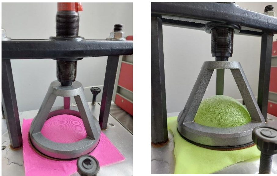
Obrázek 17. M1 (vlevo) M2 (vpravo) upnutý v přístroji Shirley Hydrostatic Head Tester M018
