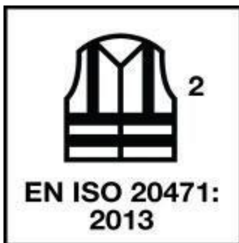
Obrázek 9. Piktogram určující zařazení do třídy dle ČSN EN ISO 20471 – Oděvy s vysokou viditelností [17]
