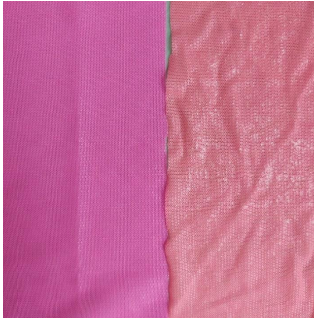
Obrázek 32. Vzhled M1 lic: před UV zářením (vlevo) po UV záření (vpravo)
