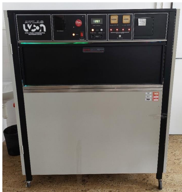
Obrázek 23. Přístroj Atlas UVCON pro simulaci UV záření
