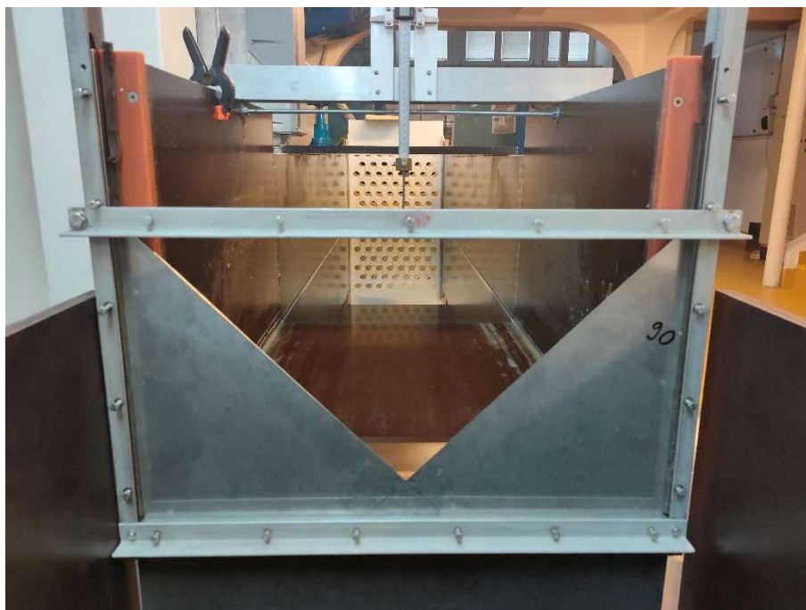
Obrázek 7 Měrný žlab – přeliv
