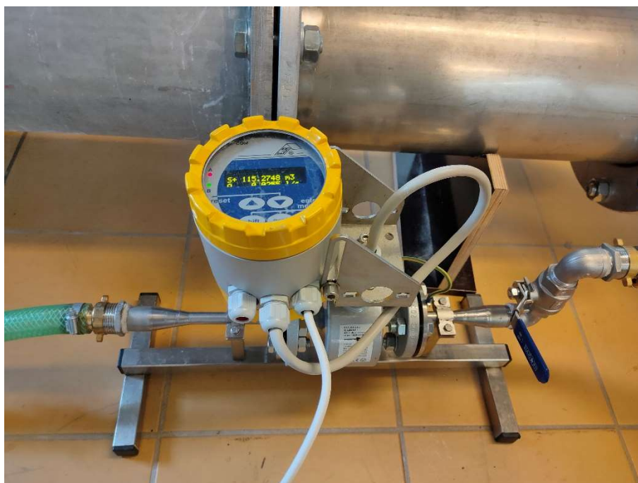
Obrázek 9 Elektromagnetický indukční průtokoměr DN10
