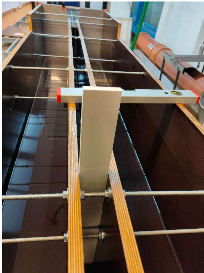
Obrázek 12 Deska pro vymezení šířky přítokového koryta
