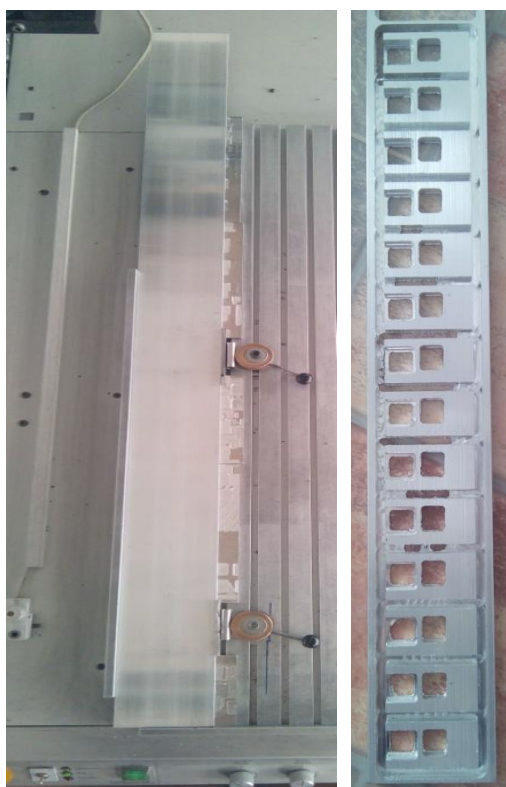
Obr. 3.1 Upnutý polotovar na stroji a polotovar po obrobení
