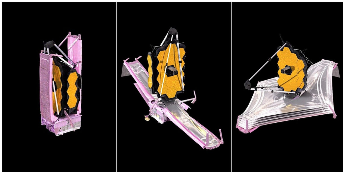
Obrázek 3.146: Mechanismus rozkládání dalekohledu Jamese Webba. Převzato z [402].
