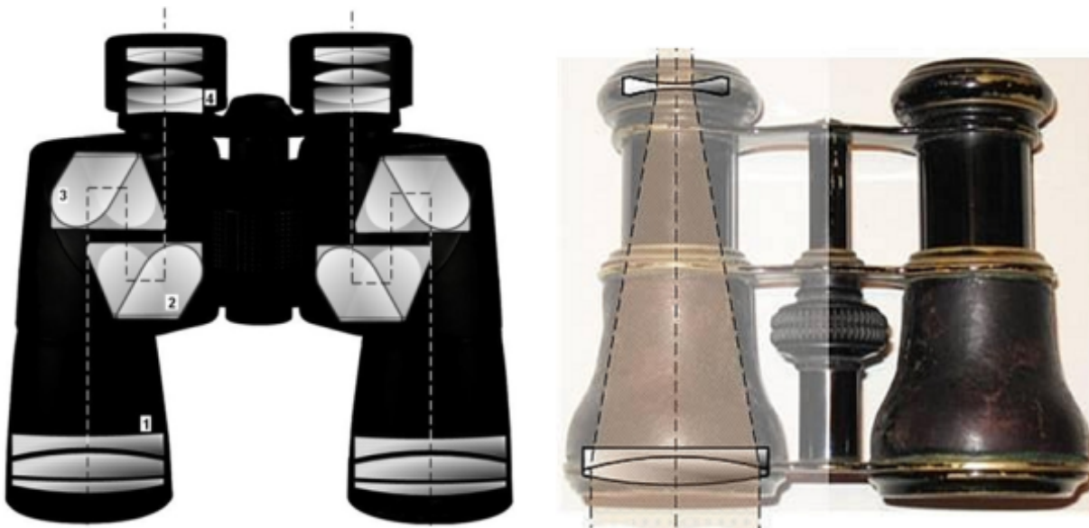
Obrázek 3.134: Konceptní srovnání triedru a divadelního kukátka. Převzato z [381] a [382].
