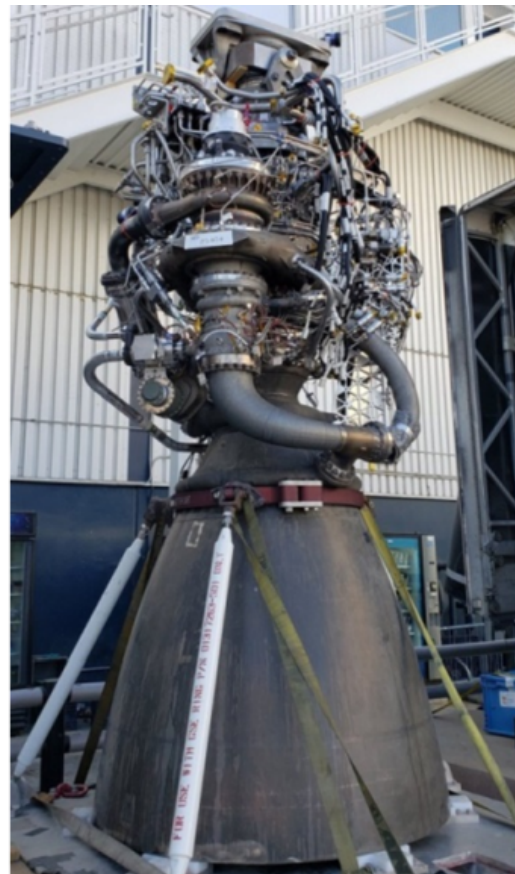
Obrázek 3.41: Raketový motor Raptor pro raketu Falcon Heavy. Vlevo schéma motoru, vpravo jeho prototyp. Převzato z [76] a [77].
