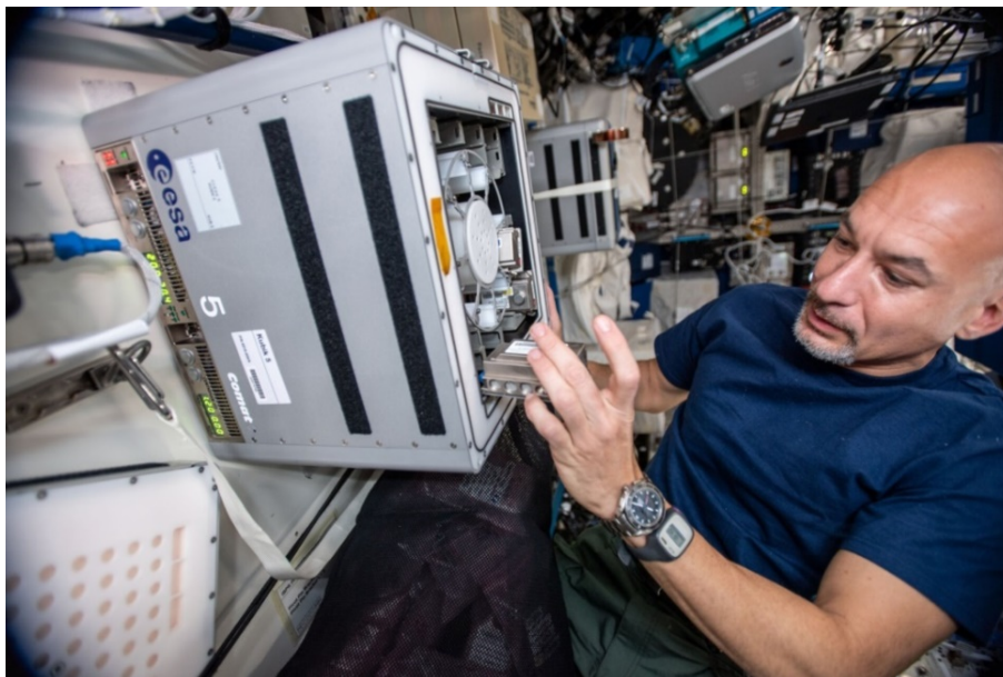
Obrázek 3.54: Italský kosmonaut Luca Parmitano a Kubik – standardizované zařízení na realizaci experimentů v modulu Columbus. Převzato z [137].
