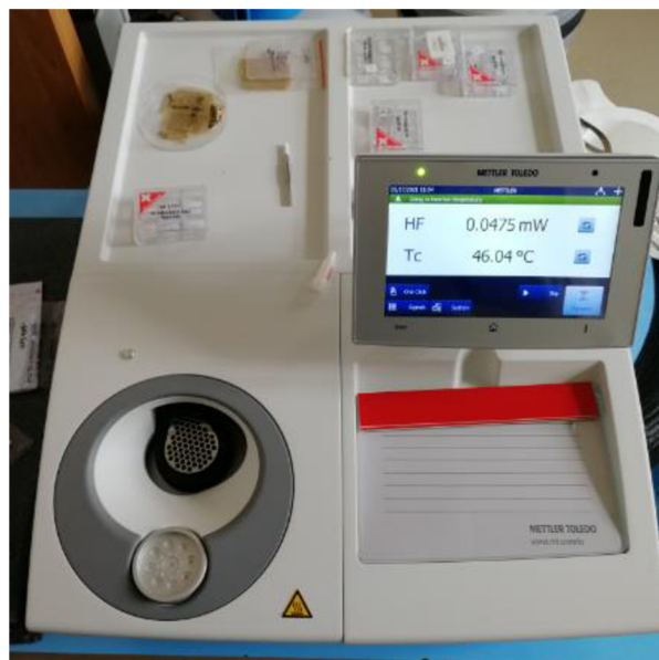
Obrázek č. 3.3.6 DSC 3+ (diferenciální skenovací kalorimetrie) pro měření tepelné charakteristiky materiálů
