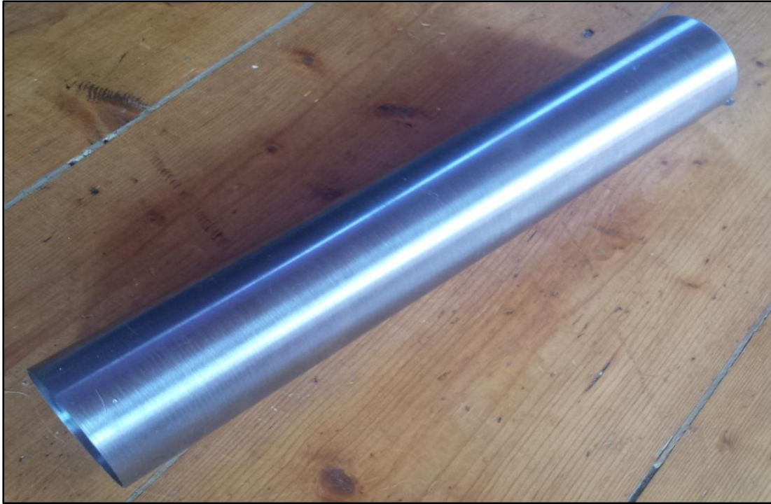
Obr. 24 Prodloužená trubka obrobená ze svařovaného polotovaru
