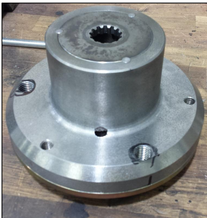
Obr. 23 Hotová příruba spojovacího hřídele se zalisovaným řetězovým kolem
