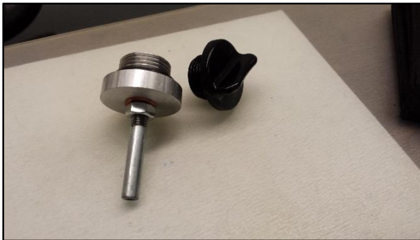
Obr. 34 Měření tlaku oleje (měřeno pod klikovou hřídelí, hned za olejovým čerpadlem)
