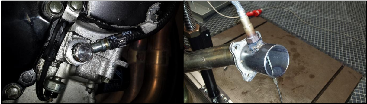
Obr. 34 Měření tlaku oleje (měřeno pod klikovou hřídelí, hned za olejovým čerpadlem)
