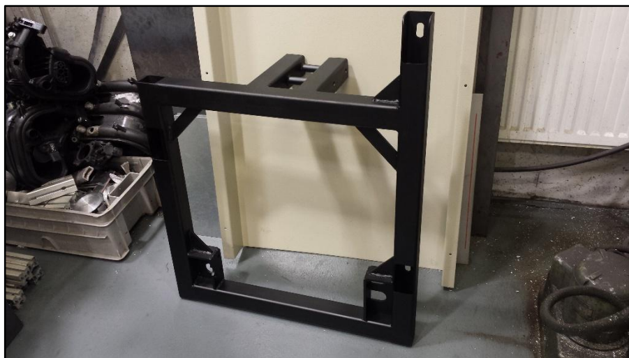
Obr. 27 Rám po svaření a nabarvení
