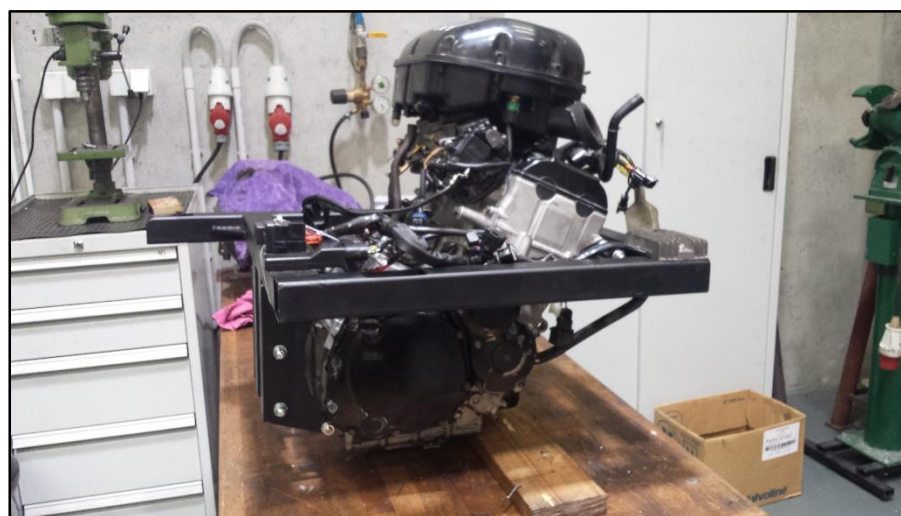
Obr. 28 Motor namontovaný v rámu
