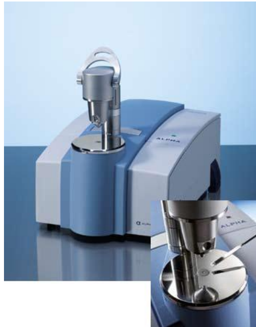
Obrázek 12: FTIR spektrometr Alpha II s modulem Platinum ATR [41]
