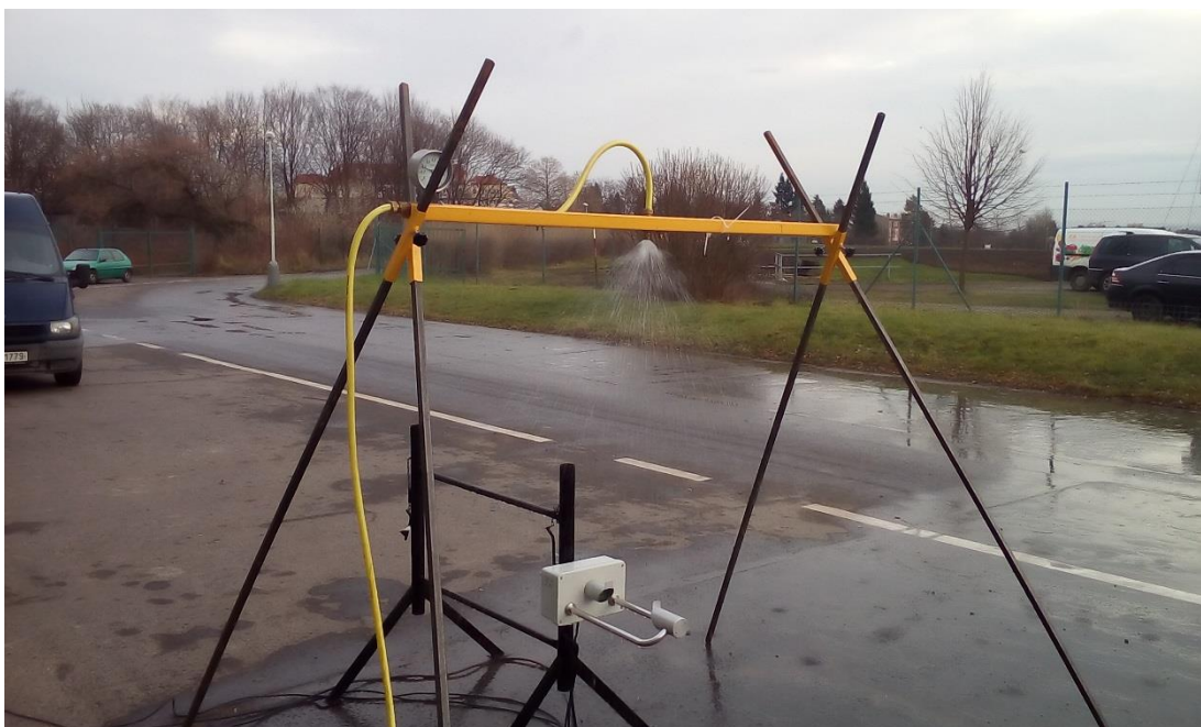
Obr. 7 Konstrukce simulátoru deště s Thiesovým disdrometrem (archiv autora).
