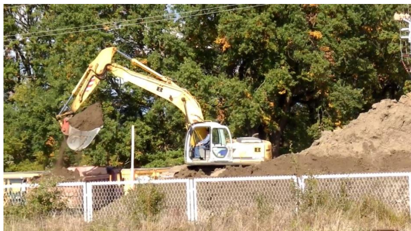
Obrázek 11 - Naplnění lopaty u rýpadla KOBELCO SK210LC
