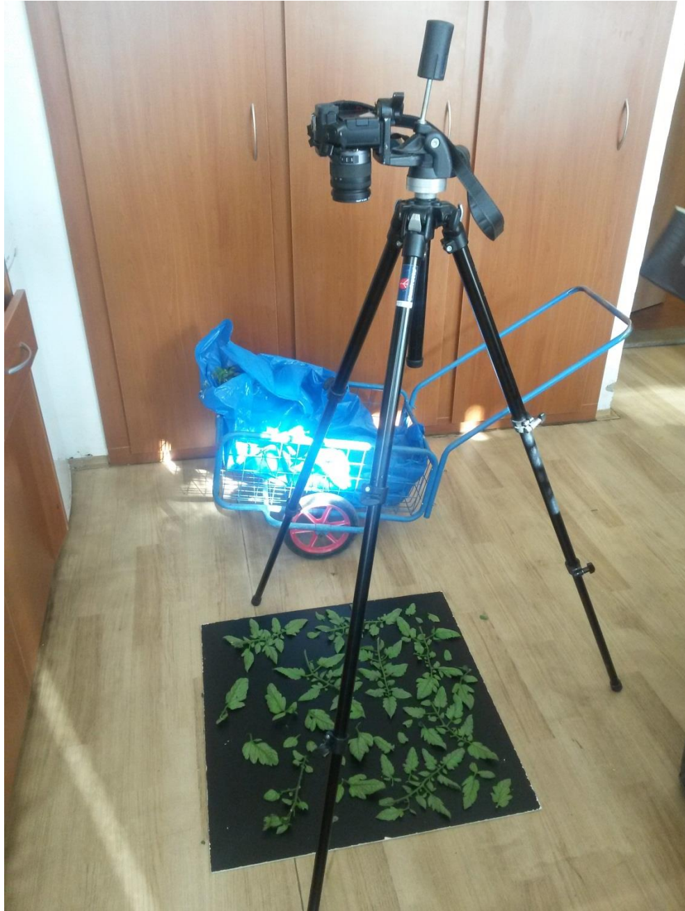
Foto 20 - Fotografování listů pro zjištění hodnoty indexu listové plochy
