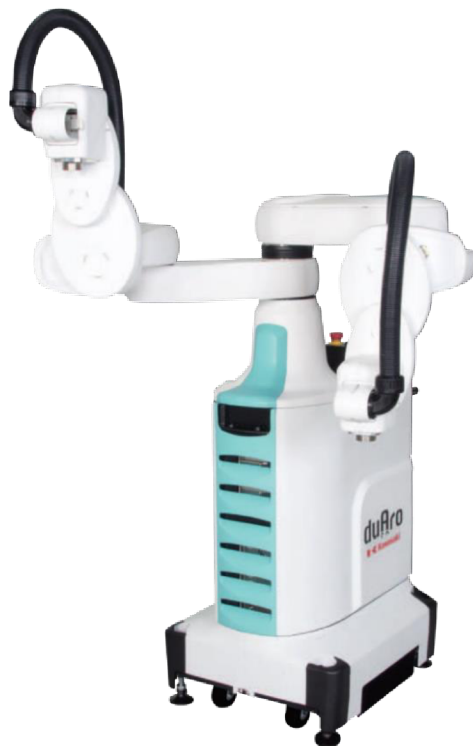
Obr. 6: Kolaborativní SCARA robot DuAro2 od společnosti Kawasaki [20]
