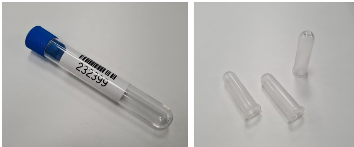
Obr. 17: Zkumavka s čárovým kódem použitá v úloze (vlevo) a reagenční nádobky (vpravo)
