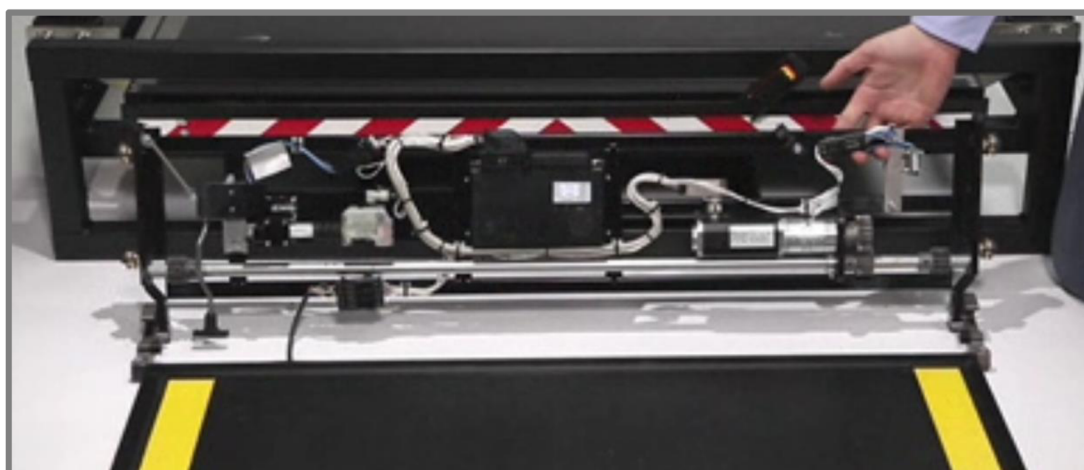
Obr. 2-11 Vysunutý mechanismus rampy Skadi [15]
