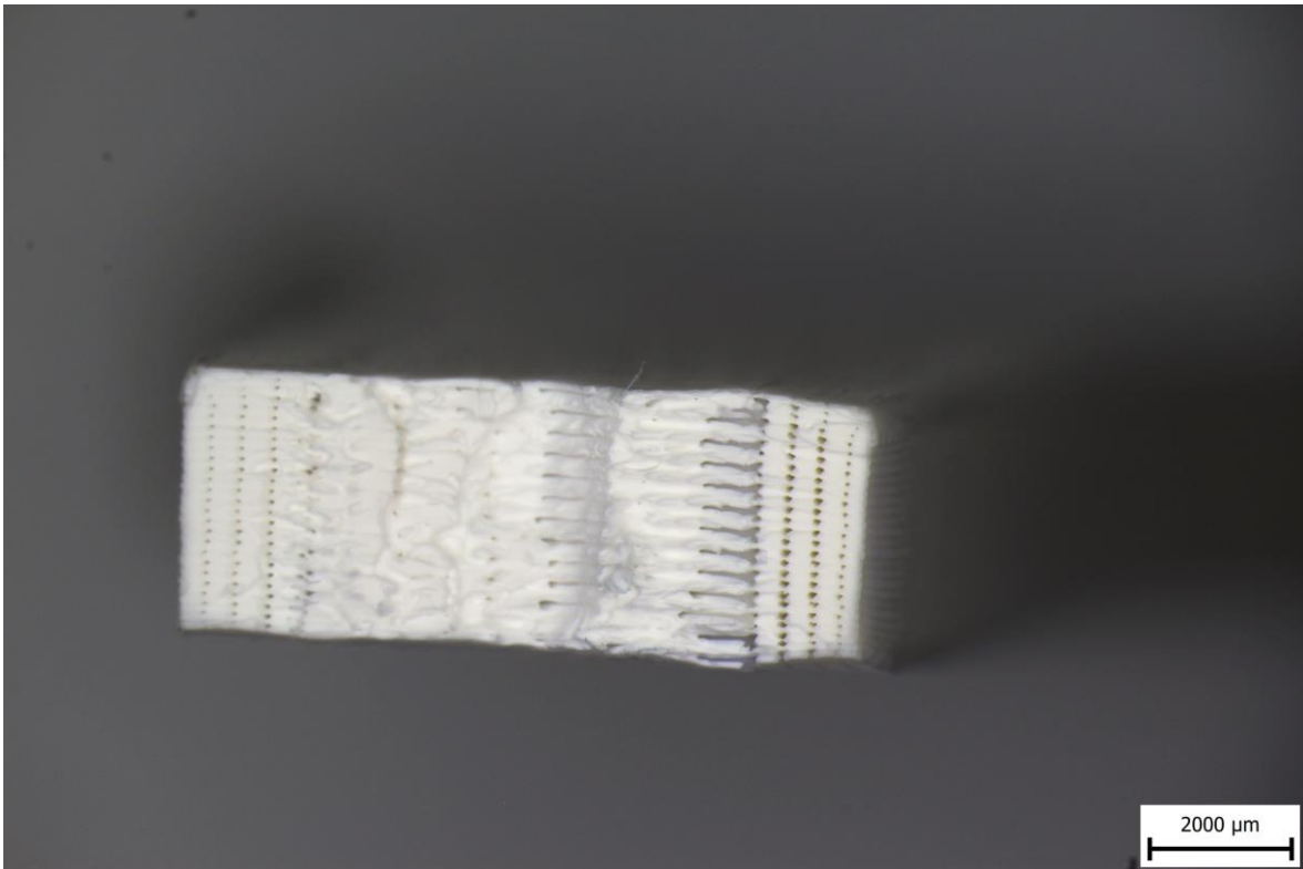
Obr. 37 Lomová plocha u vzorku vyrobeného metódou FDM, materiál ASA
