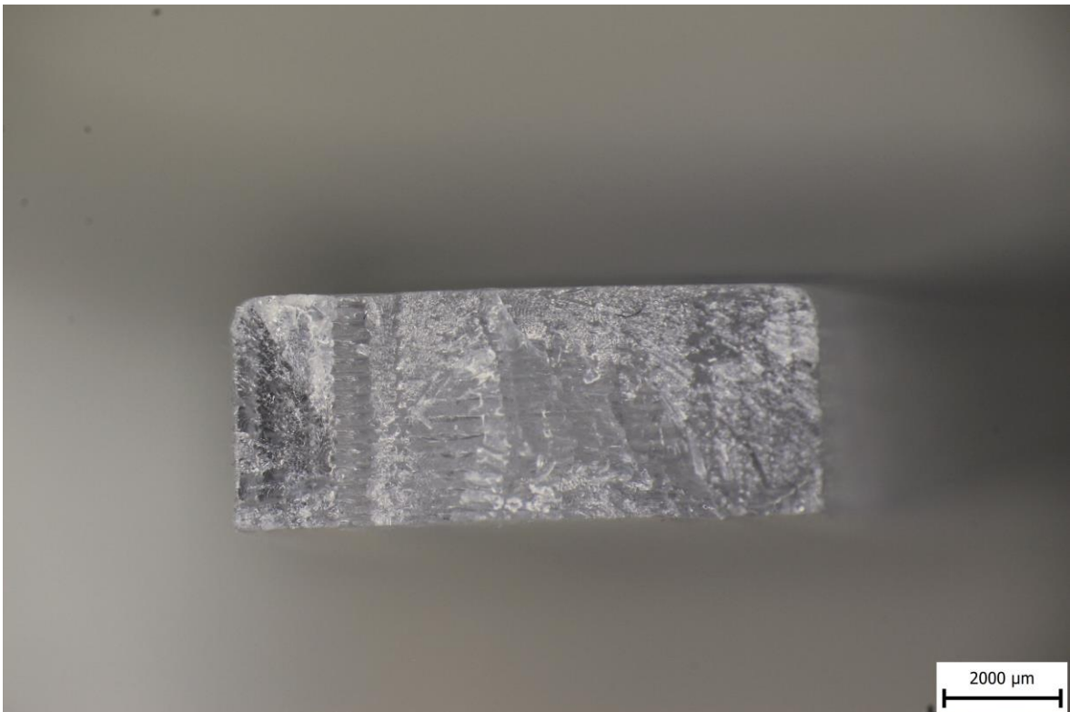
Obr. 38 Lomová plocha u vzorku vyrobeného metódou FDM, materiál CPE
