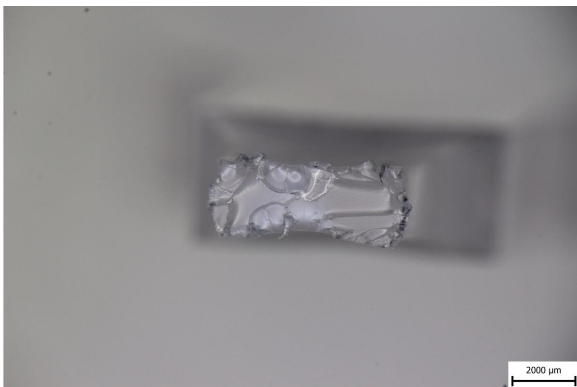
Obr. 36 Lomová plocha u vzorku vyrobeného metódou injekčného vstřikování plastů, materiál CPE
