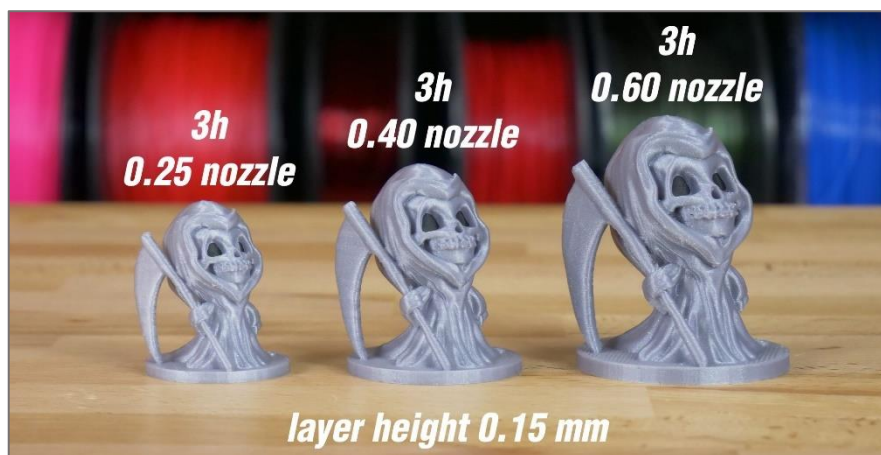
Obr. 11 Délka tiskového času při stejné výšce vrstvy ale při jiné [23]
