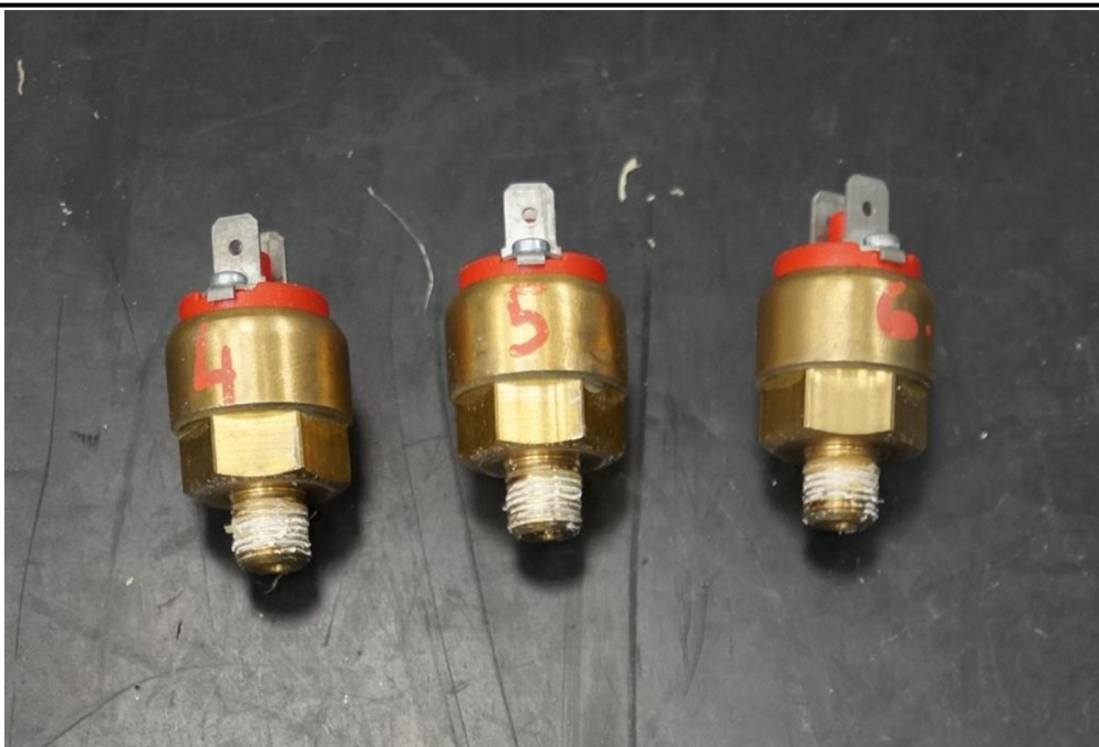
Obr. 9 – testované spínače Thermis 214 002
