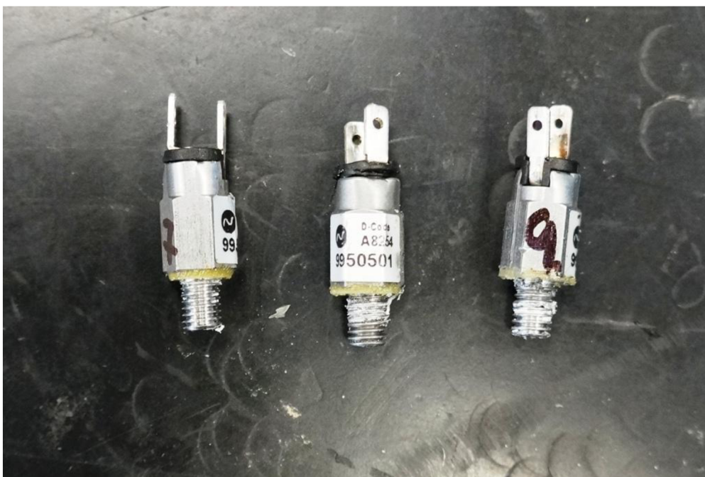
Obr. 10 – testované spínače IMI Norgren Mini 9950
