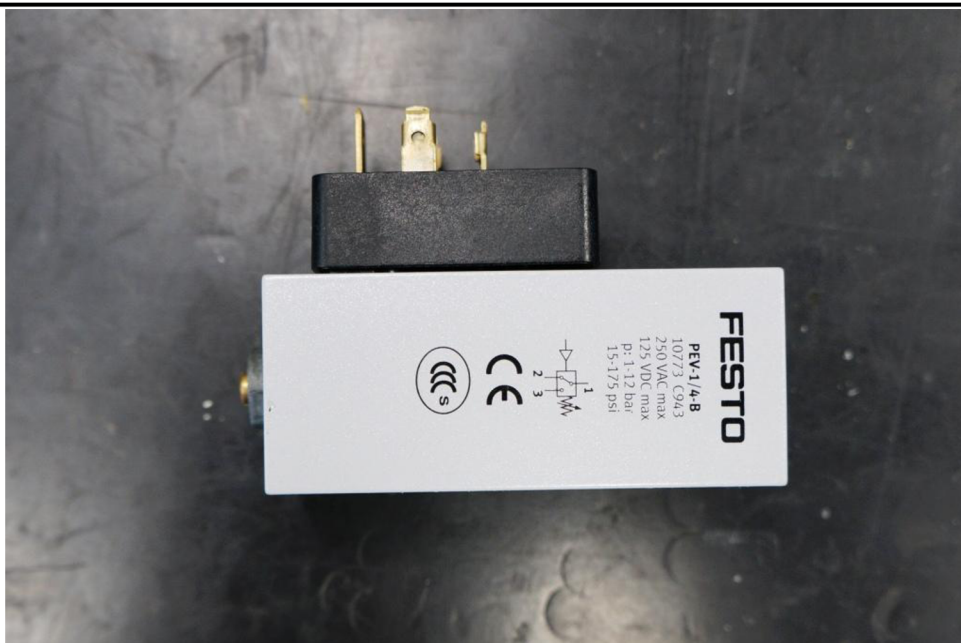
Obr. 12 – testovaný spínač FESTO PEV-1/4-B
