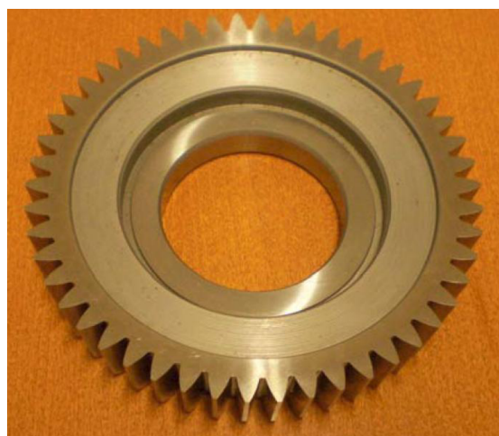
Obr. 2.7 Obrážecí kotoučový nůž nástrčný [9]
