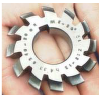
Obr. 2.2 Kotoučová modulová fréza [10]
