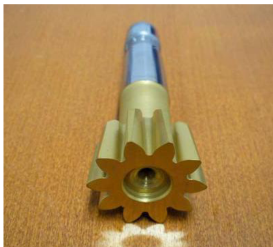
Obr. 2.6 Obrážecí kotoučový nůž stopkový [8]
