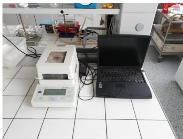
Obr. Příloha 4: Analyzátor vlhkosti zapojený do notebooku
