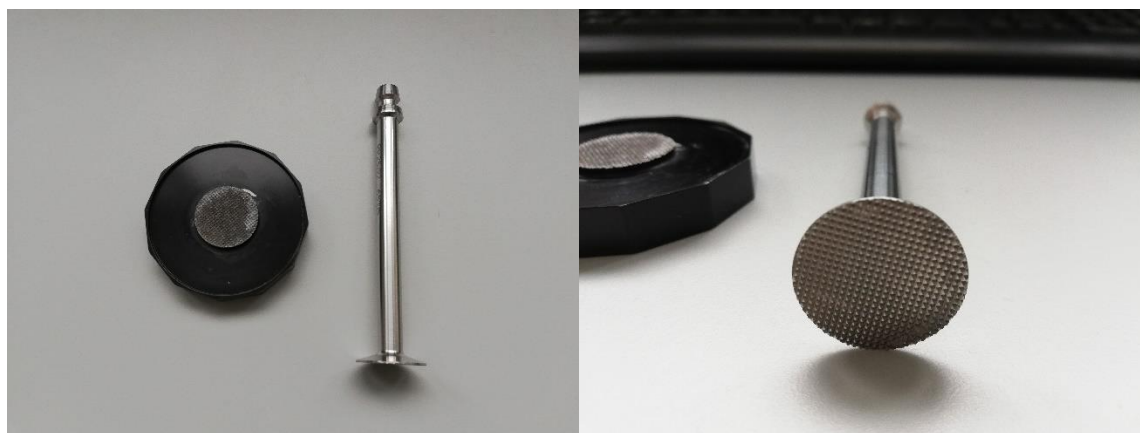
Obr. Příloha 3: Spodní a horní část vroubkované geometrie v nastavení deska-deska pro měření hydrogelových vzorků
