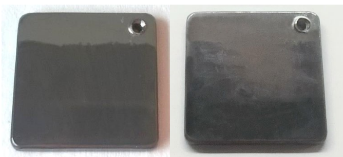
Obrázek 17: Vrstva sol-gelu před a po mikrobiologických testech.
