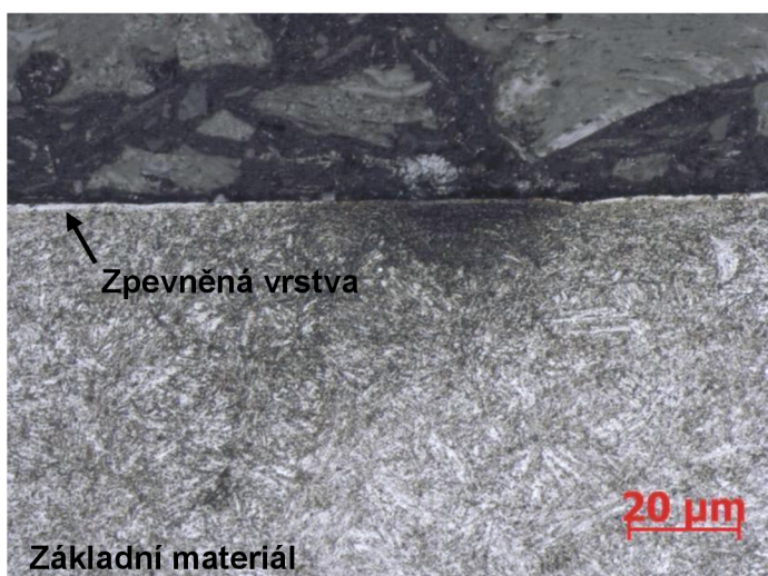
Obr. 5.23 Metalografický výbrus vzorku W1A
