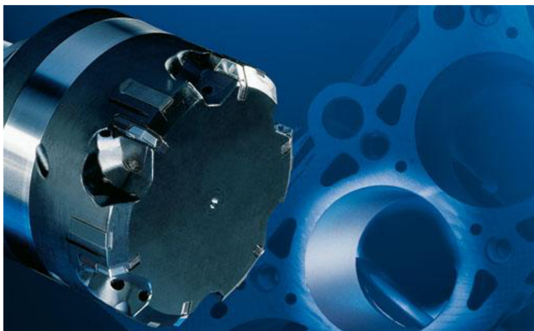
Obr. 4.5 Vystružování bloků motorů 51
