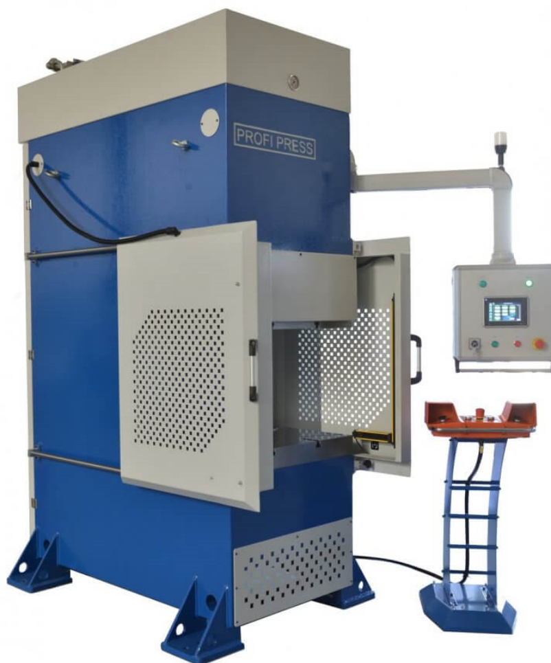
Obr. 42 Hydraulický lis PPCT [32].
