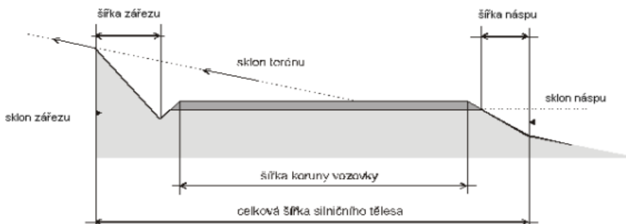
Obr. č. 10 Příčný řez lesní cestou (Hanák, 2002)
