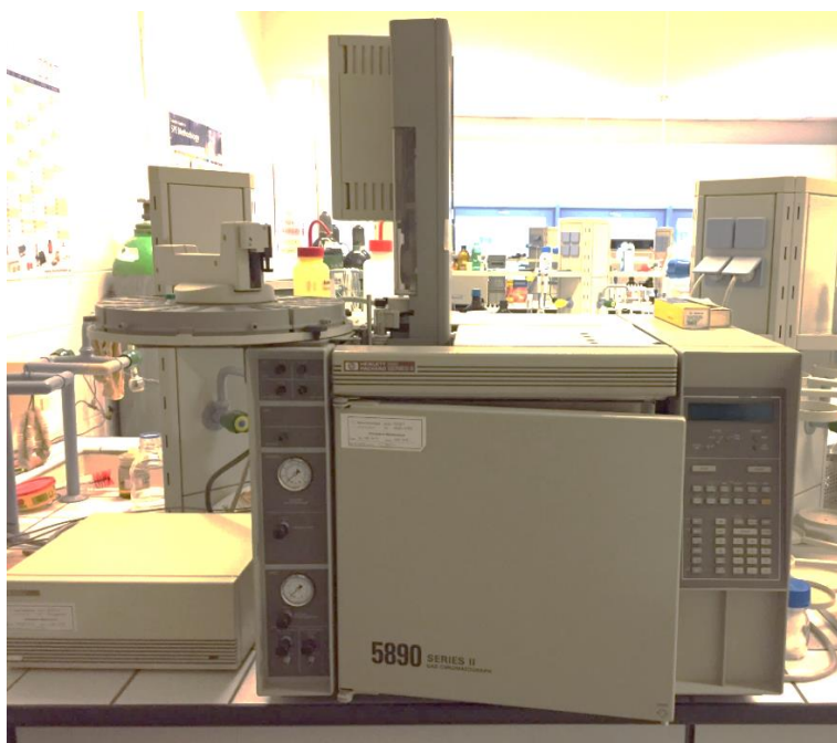
Obrázek 19: Plynový chromatograf HP 5890 Series II
