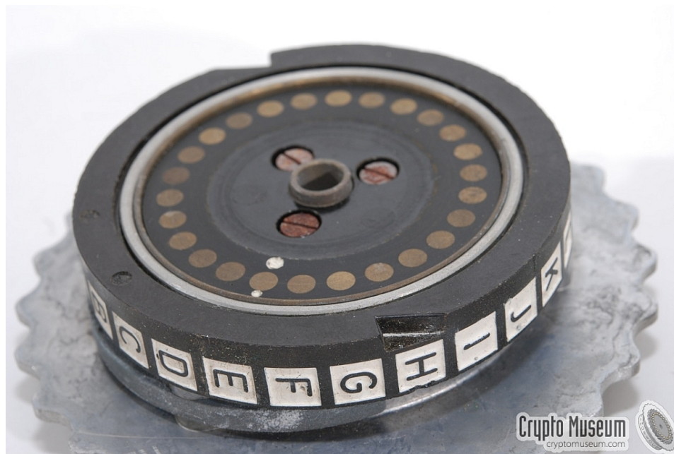
Obrázek 7. Zářezy na rotoru [1]
