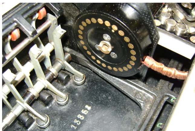
Obrázek 4. Pohled na vstupní kruh rotorů [2]
