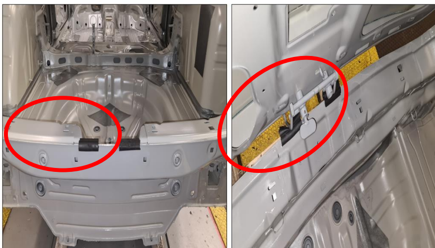
Obrázek 8: Použití nastříhaného těsnění jako zabezpečovací prvek 5. dveří surové karoserie (zdroj: Interní materiály Škoda Auto a.s., 2021).
