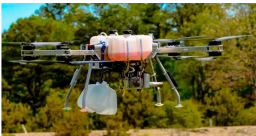
Obr. 18 Dron s palivovou nádrží
