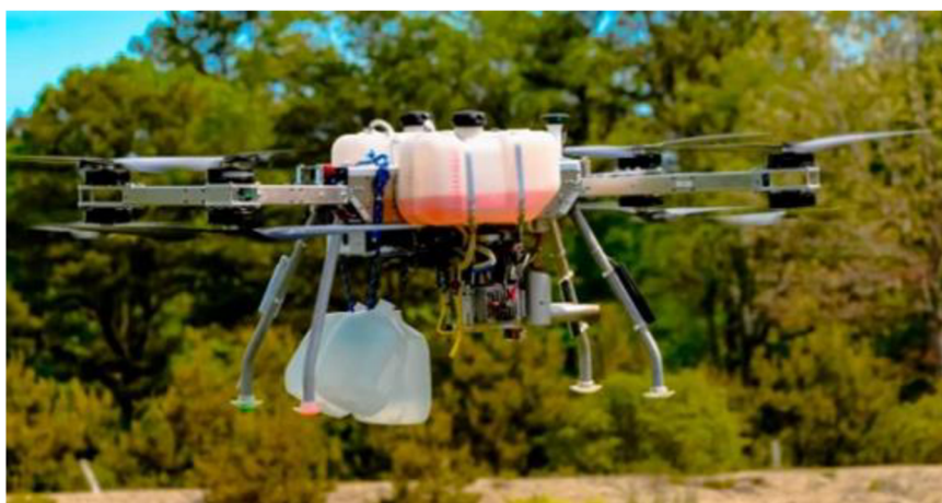
Obr. 18 Dron s palivovou nádrží
