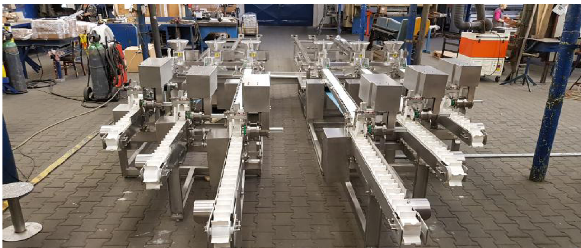
Obrázek č.8. Linka na výrobu, formování, solení a namotávání pařeného sýra Parenice – montáž.
