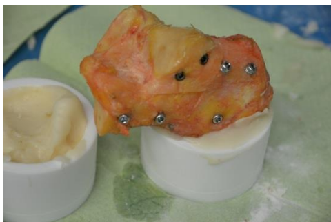
Obr. 22 - Zavedený implantát v patní kosti po osteosyntéze (C-NAIL) upevněný do fixačního zařízení.
