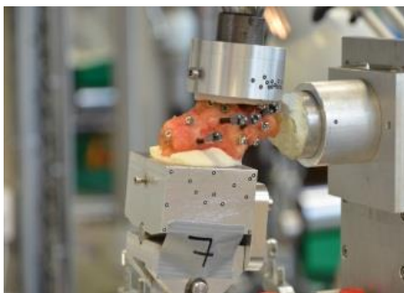
Obr. 24 – Patní kost se zavedeným implantátem připravená k biomechanickému testu.
