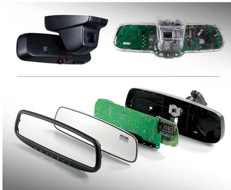
Obrázek 1.1 Struktura elektrochromického zpětného zrcátka [2]
