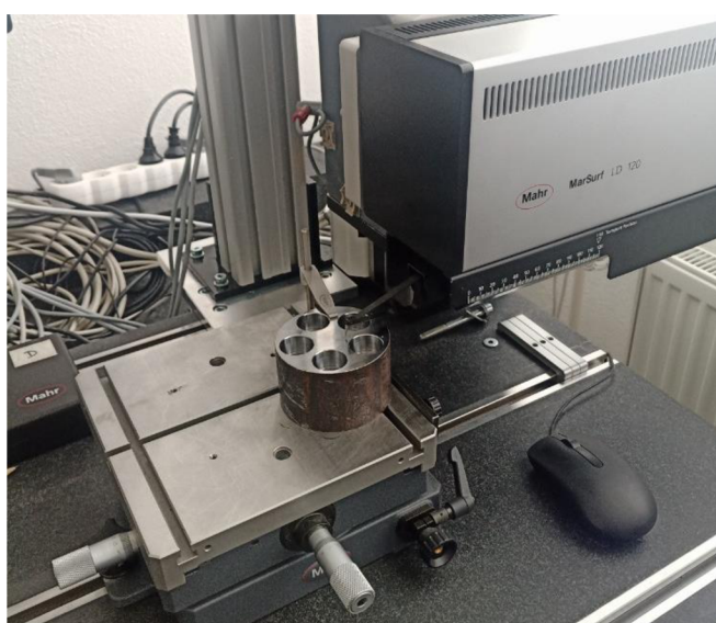
Obrázek 41 - Měření drsnosti čela součásti
