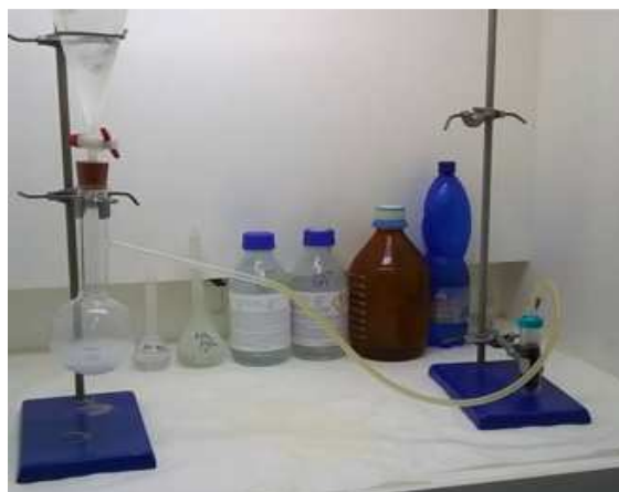
Obr. 5: Výroba CO 2 a jeho přivádění do suspenze s AMO
