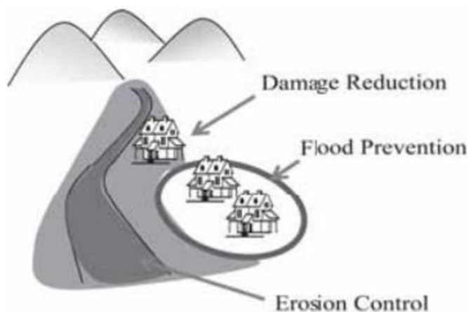
Obrázek 9 Kombinace ochrany proti záplavám v Japonsku (Shaw, Rajib & Uy, Noralene & Baumwoll, Jennifer, 2008:24)
