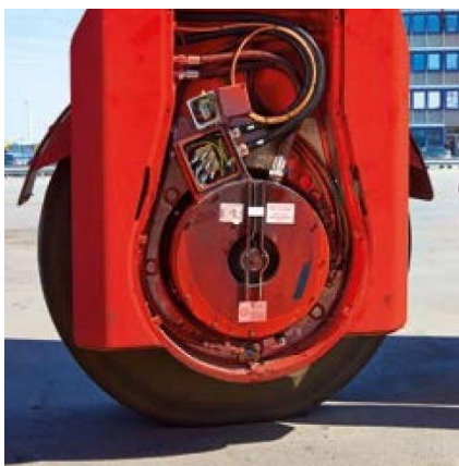
Obr. 5 Asynchronní motor v náboji kola [10]
