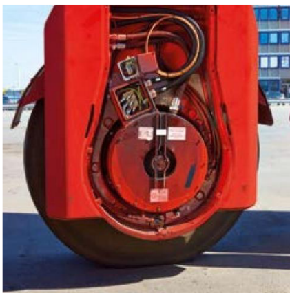
Obr. 5 Asynchronní motor v náboji kola [10]
