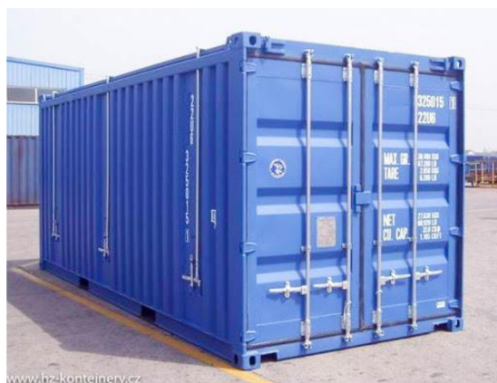
Obr. 3 Standardizovaný 20stopý kontejner [15]
