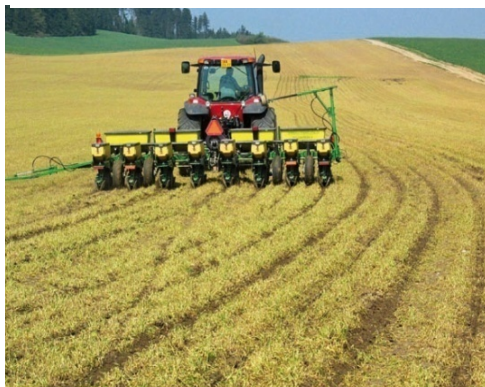
Obr. 12 Kukuřice setá bezorebným secím strojem do mulče žita, (foto: ZEA Sedmihorky)
