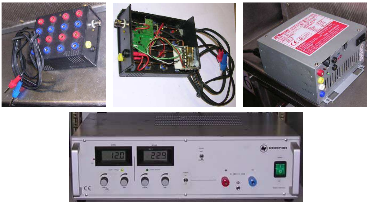
Obr. 32 Fota napájecích zdrojů
