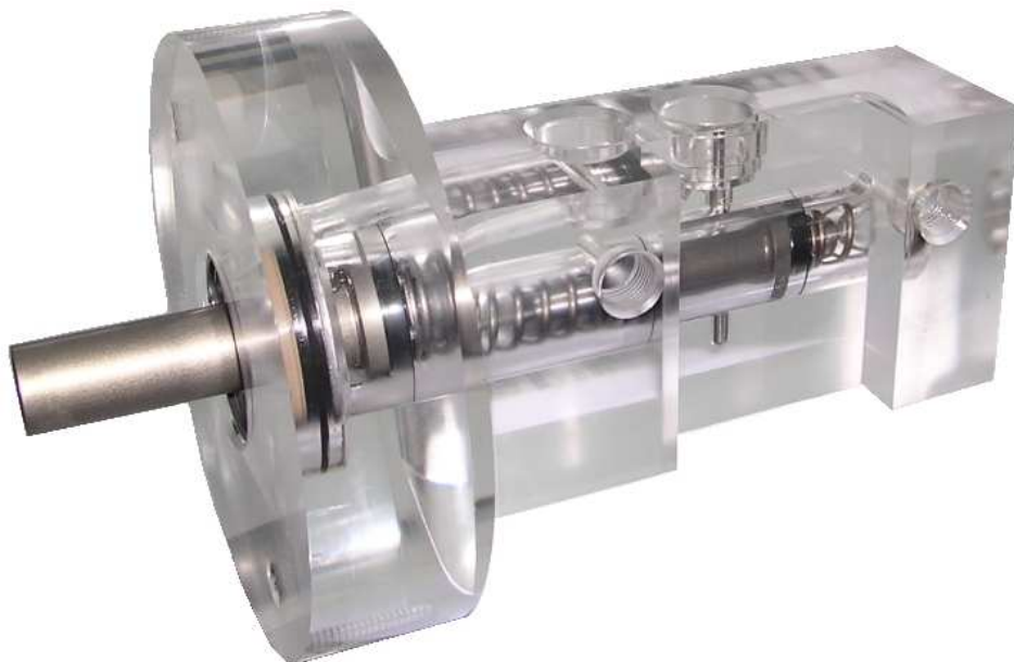
Obr. 17 Průhledný model brzdového válce
