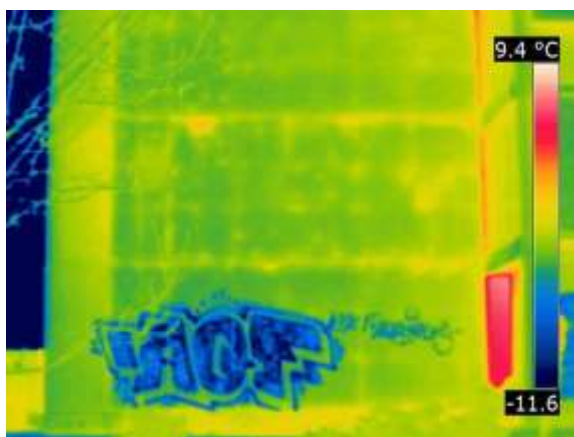
Obrázek 1.15 Snímek z nesprávně nastavené termografické kamery (vliv emisivity); zdroj: http://www.termokamera.cz/princip-a-funkce/tepelne-zareni/
