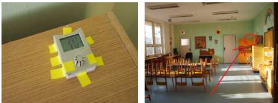
Obrázek 2.266 Upevnění dataloggeru a umístění v místnosti herny mateřské školy
