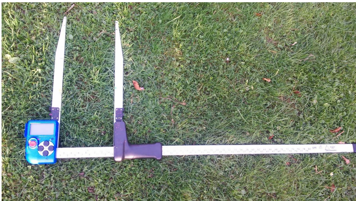
Příloha č. 3: Elektronická registrační průměrka Digitech Professional se softwarovým vybavením LCRTax 1.03 a s 80 cm stupnicí
