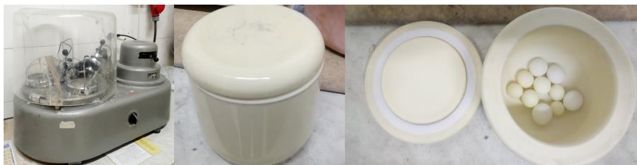
Obr. 14: planetární mlýn, uzavřená mlecí miska a otevřená mlecí miska s mlecími kuličkami
