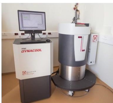
Obrázek 18: Systém na měření fyzikálních vlastností PPMS Dynacool jehož součástí je i VSM.
