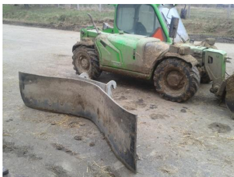
Obrázek 43 – Šípová radlice vlastní výroby v ZOD Hořice.
