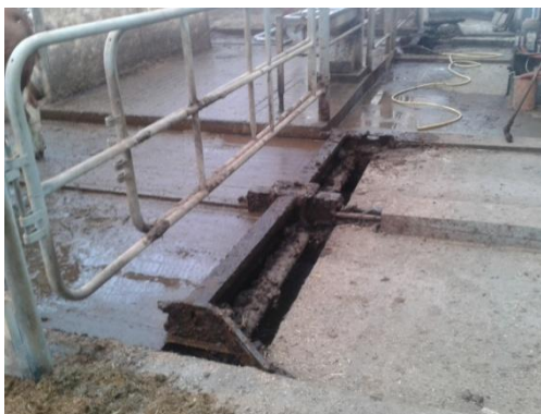
Obrázek 38 – Hydraulické shrnovací lopaty na Školním statku v Humpolci.
