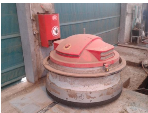
Obrázek 34 – Automatický přihrnovač krmiva Lely Juno 150.
