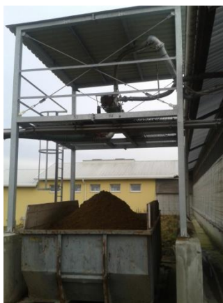
Obrázek 33 – Šnekový separátor kejdy na Školním statku v Humpolci.
