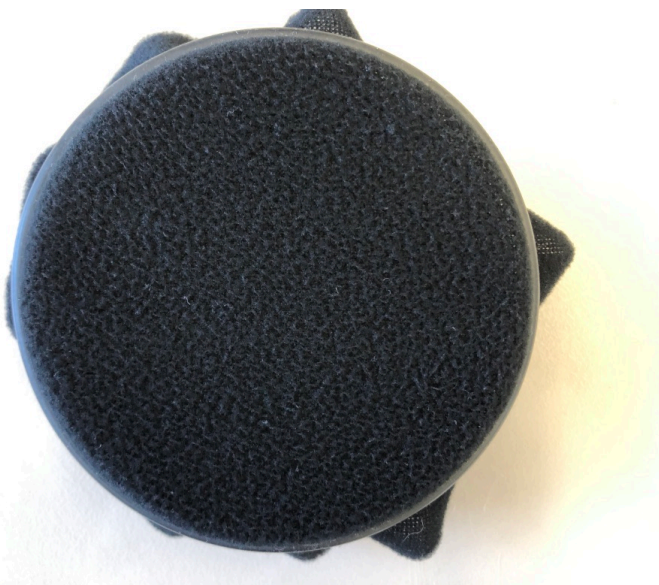
Obrázek č.: vzorek pleteniny s fleecem po 5000 otáčkách
