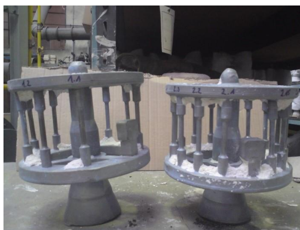
Obr. 11: a) forma pro odlití b) předlité tyče
