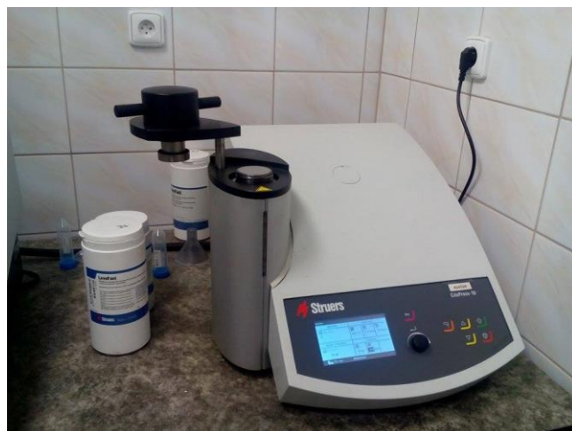
Obr. 15: Lisovací stroj Struers citopress 10
