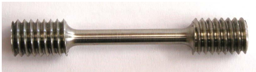
Obr. 14: Tahový zkušební vzorek ( d_0 = 6 mm, L_0 = 30 mm)
