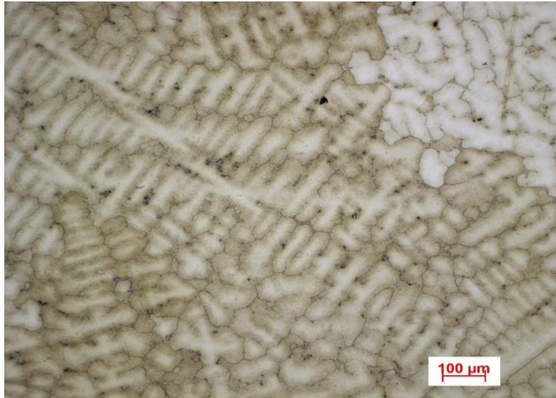
Obr. 16: Dendritická struktura, vz. předlitý bez TZ
