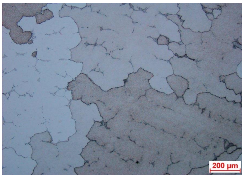
Obr. 26: Zhomogenizovaná struktura, s eutektikem, vz. komolokužel HIP+TZ
