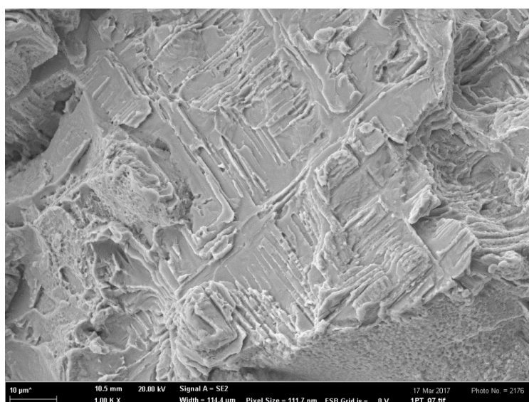
Obr. 40: Lomová plocha vzorku po tahové zkoušce, vz. předlitý po TZ
