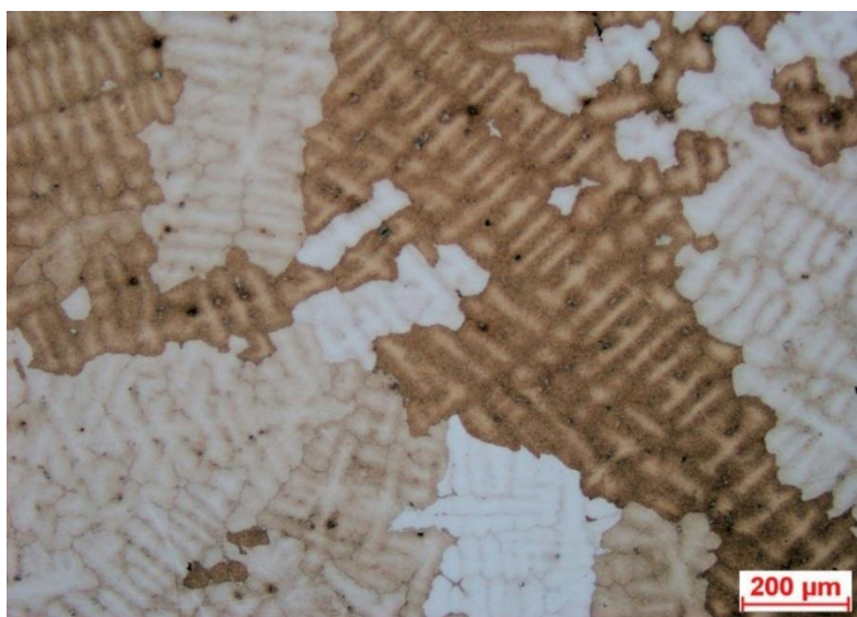
Obr. 18: Dendritická struktura – lehce zhomogenizovaná, vz. předlitý s TZ
