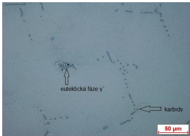
Obr. 29: Eutektická fáze \gamma' , karbidy vz. blok bez TZ
