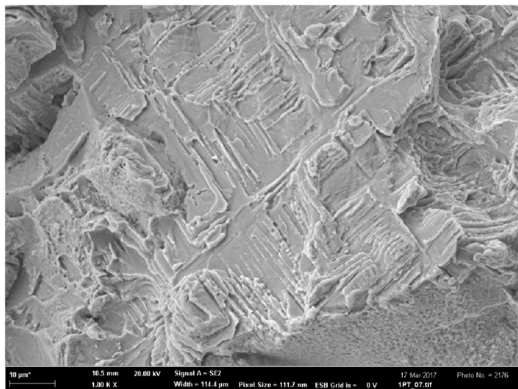
Obr. 40: Lomová plocha vzorku po tahové zkoušce, vz. předlitý po TZ
