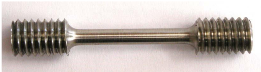
Obr. 14: Tahový zkušební vzorek ( d_0 = 6 mm, L_0 = 30 mm)
