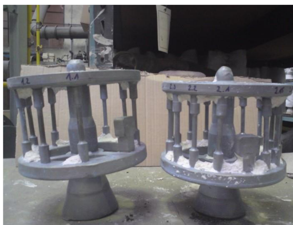
Obr. 11: a) forma pro odlití b) předlité tyče
