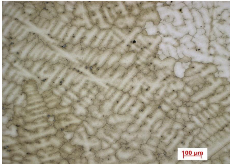
Obr. 16: Dendritická struktura, vz. předlitý bez TZ
