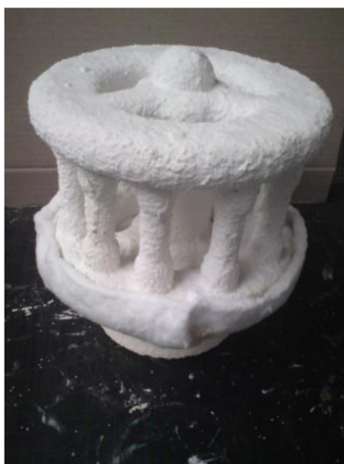
Obr. 11: a) forma pro odlití b) předlité tyče
