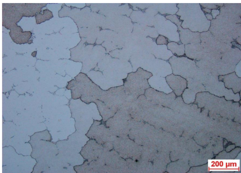
Obr. 26: Zhomogenizovaná struktura, s eutektikem, vz. komolokužel HIP+TZ
