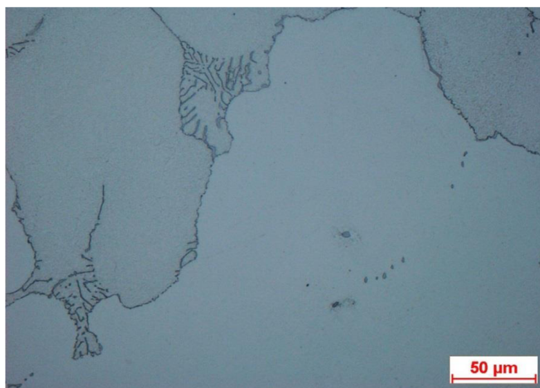
Obr. 25: Karbidy typu MC vyloučené po hranicích zrn, vz. komolokužel s TZ
