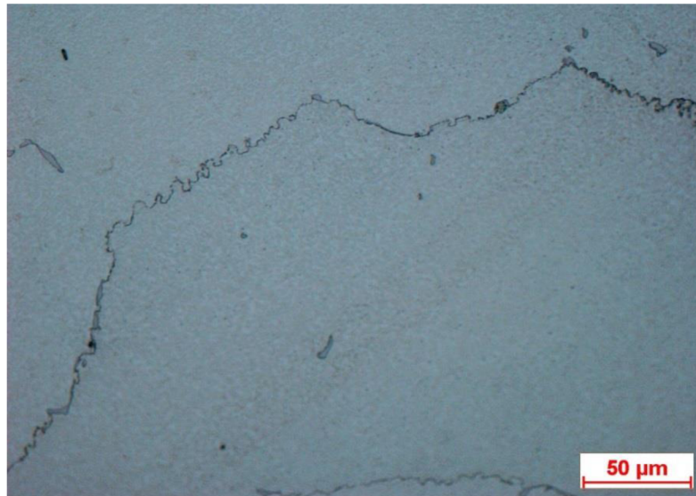
Obr. 33: karbidy, zoubkování, fáze \gamma' , vz. blok HIP+TZ
