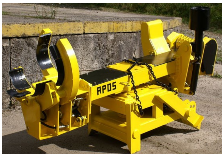
Obr. 18 – Protahovací odvětvovač SV 6-098 APOS. [16]
