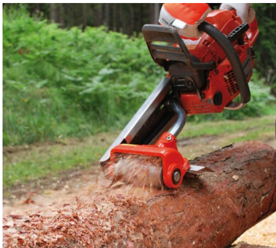
Obr. 19 – Odkorňování motorovou pilou s frézovacím adaptérem. [22]
