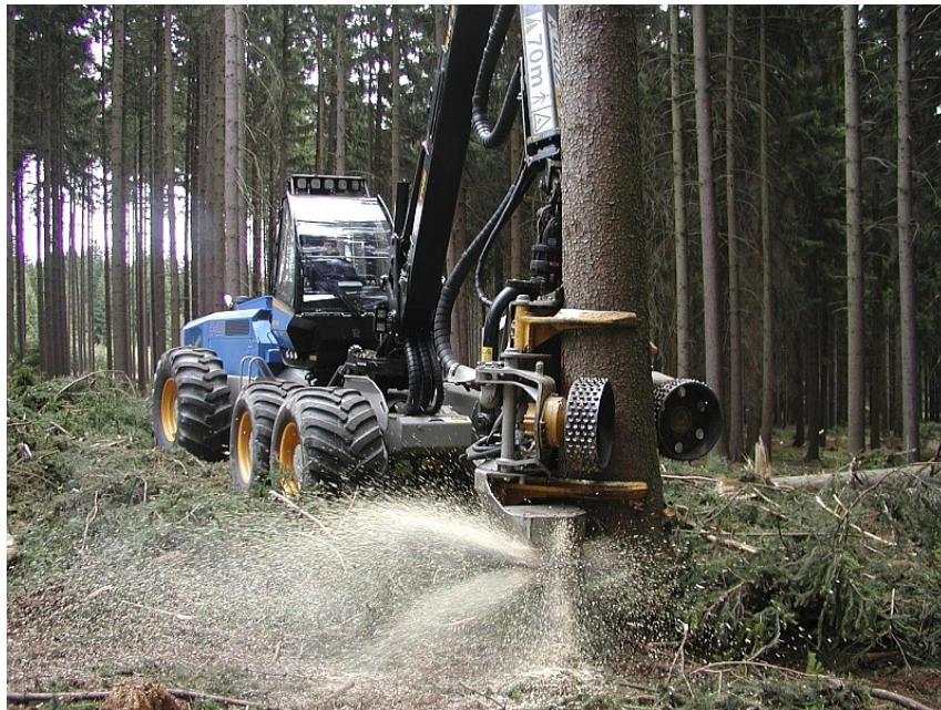
Obr. 16 – Kácení stromu harvestorem. [27]
