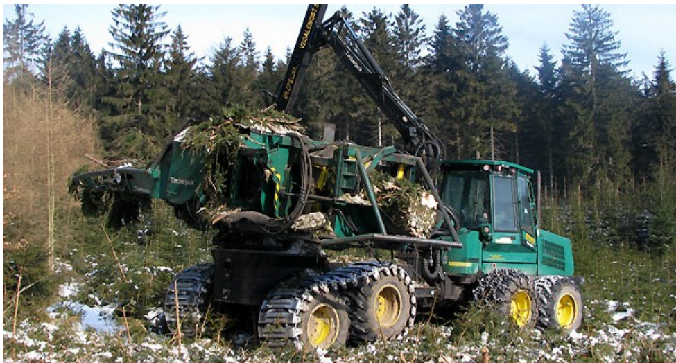
Obr. 5 – Balíkování klestu balíkovačem Timberjack 1490D. [24]
