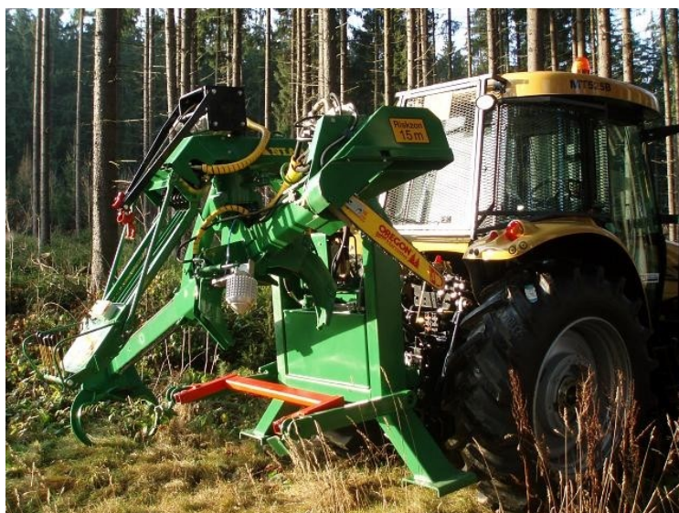
Obr. 21 – Traktorový procesor NIAB 5-15B určený ke krácení a odvětňování probírkových sortimentů. [23]
